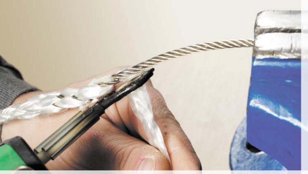
Litzen mit Hilfe des Heißschneiders abschweißen.
