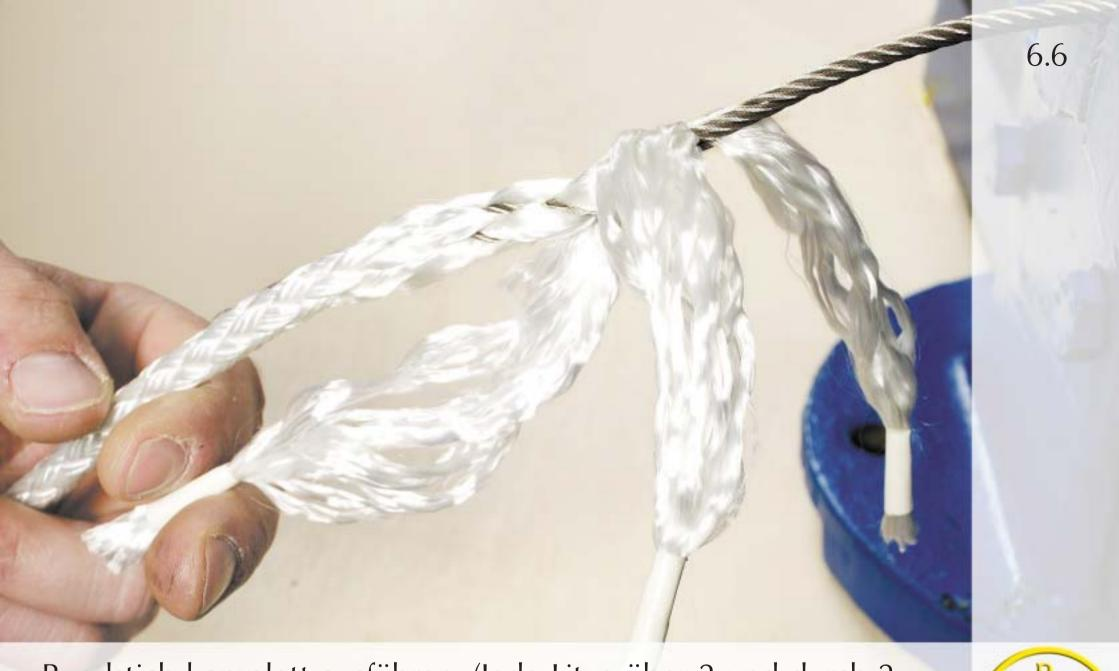
Rundstich komplett ausführen. (Jede Litze über 2 und durch 2 Drahtlitzen hindurchstecken.) Es müssen mindestens 3 komplette Rundstiche durchgeführt werden.
