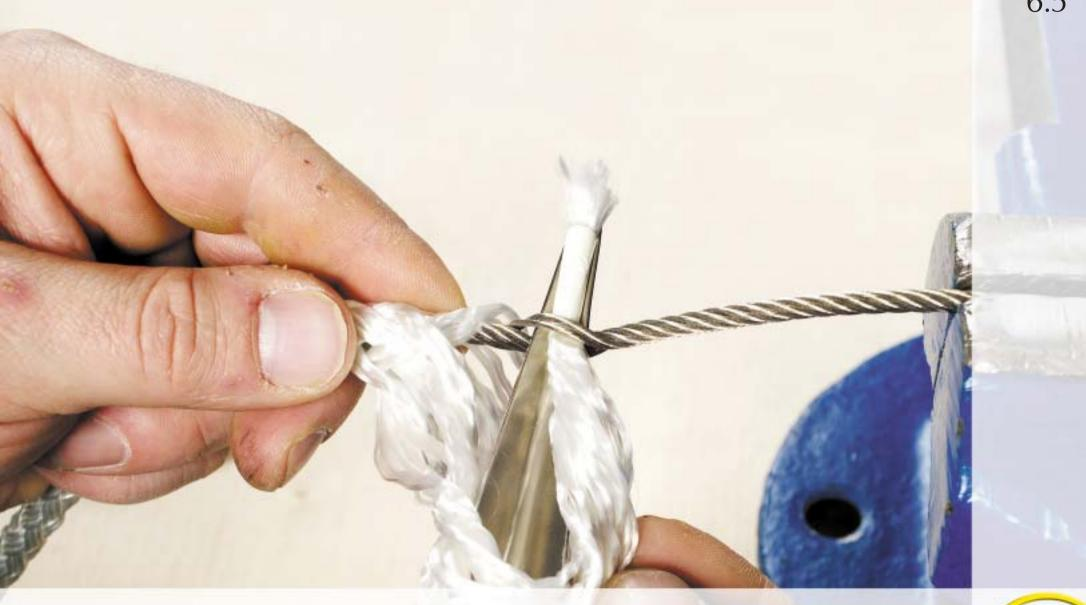
Die erste Litze mit Hilfe des Hohlspiekers unter 2 Drahtlitzen durchziehen.
