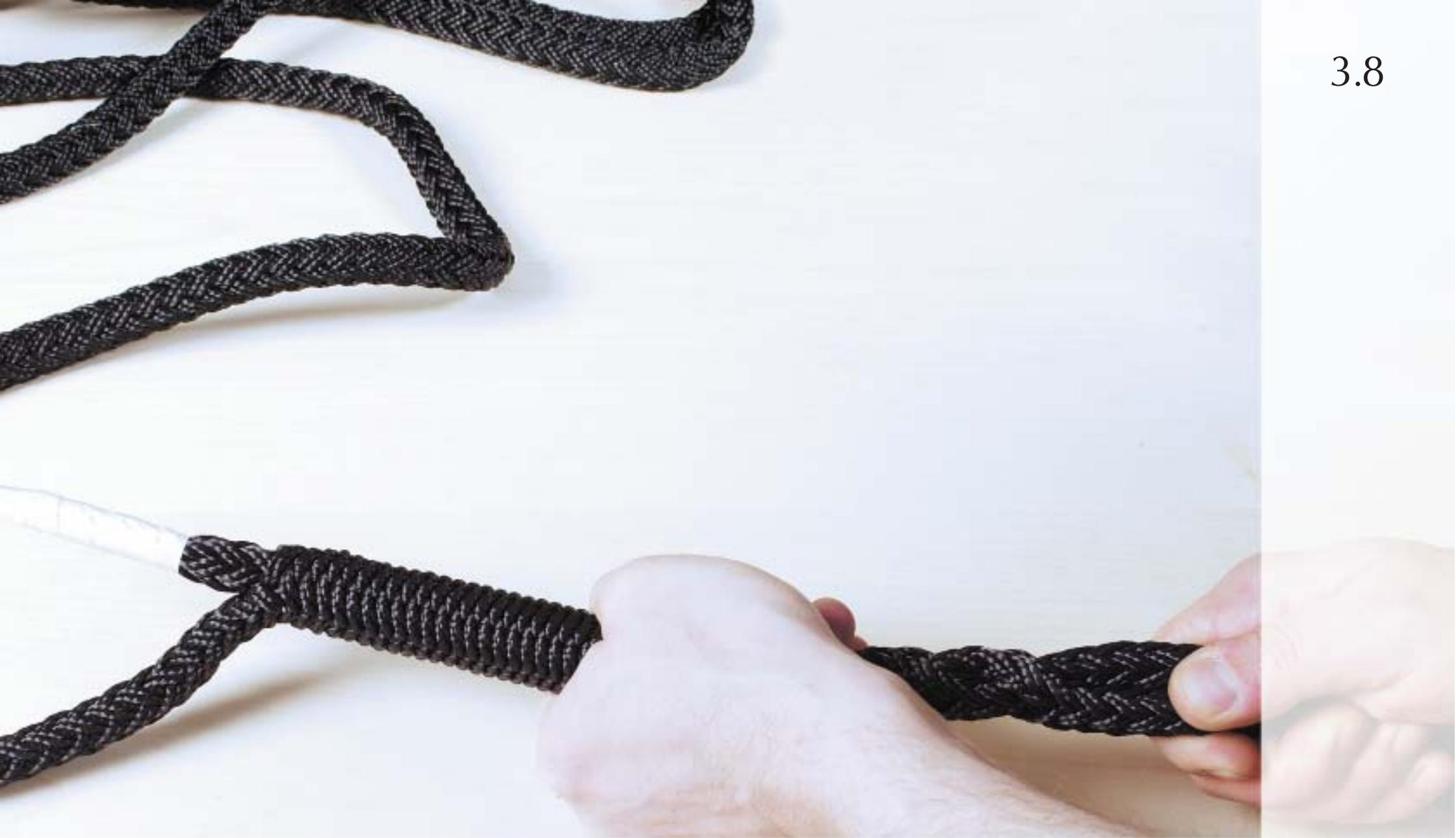
Tape entfernen und Geflecht leicht verjüngen. Geflecht über das eingespleißte Seilende melken, so dass dieses komplett in dem Seil verschwindet.
