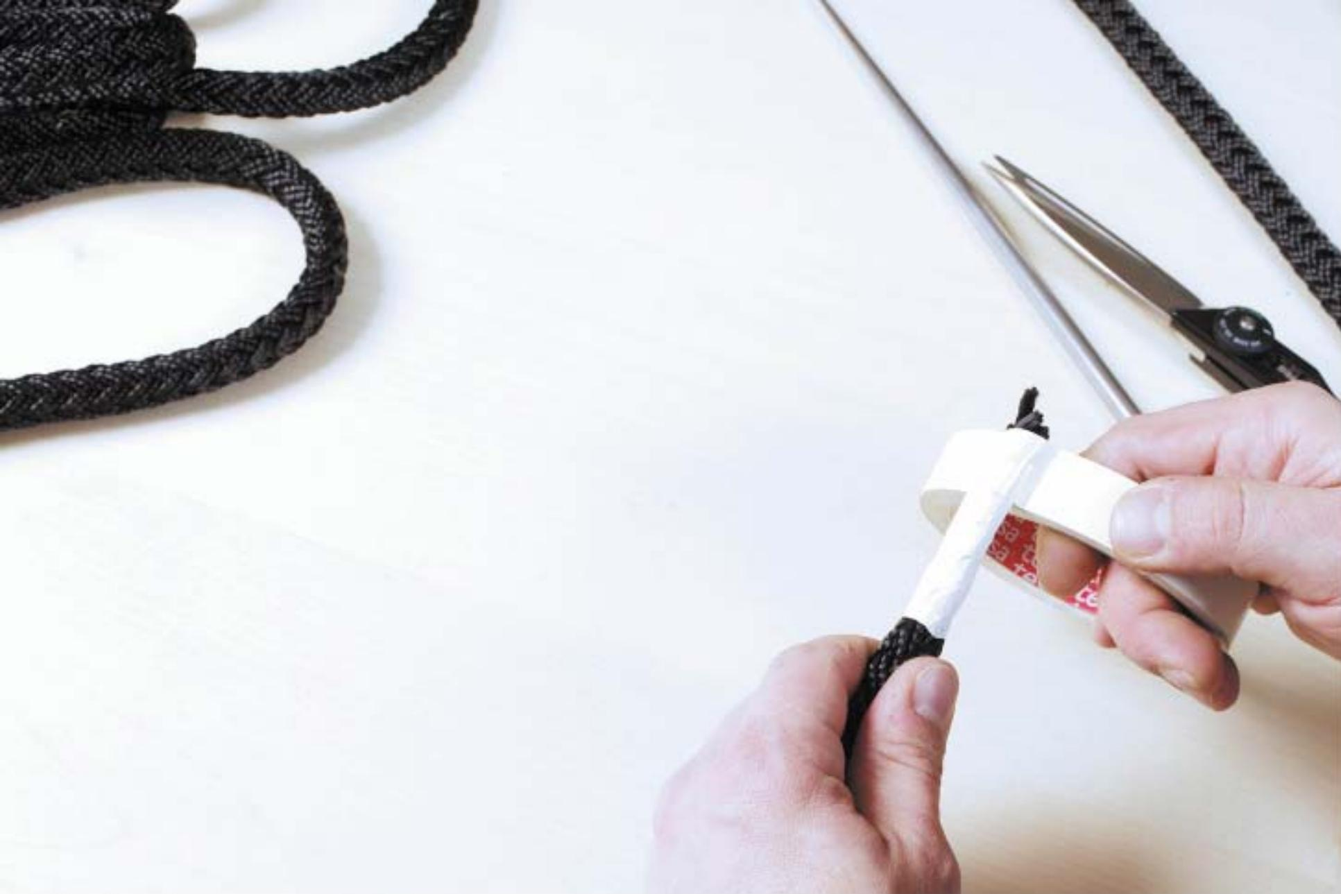
Mit Tape abkleben. So dass eine Spitze entsteht
