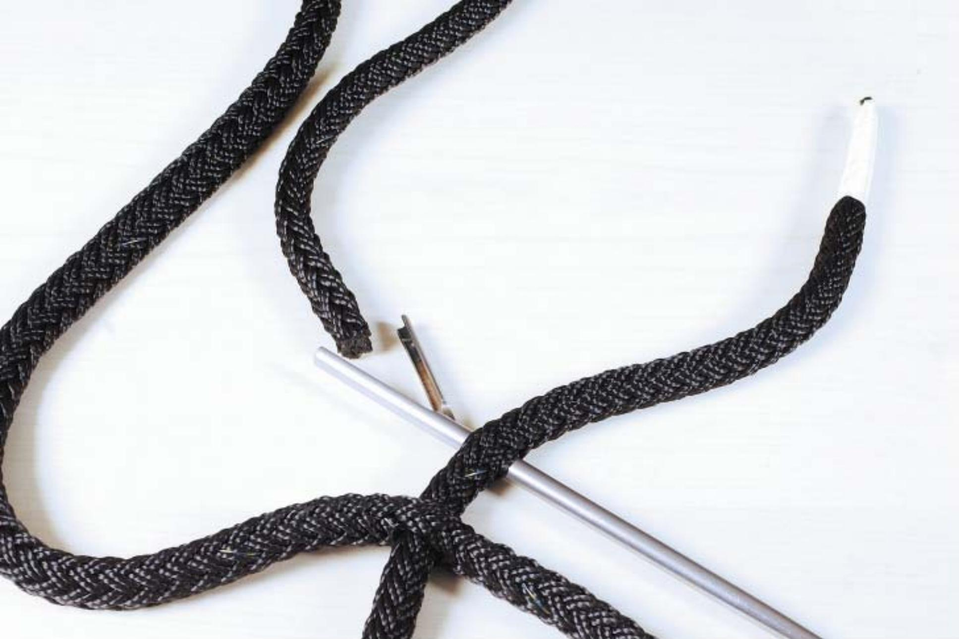
Das lange Ende des Seiles durch das Kurze, wie abgebildet, durchstecken und festziehen.
